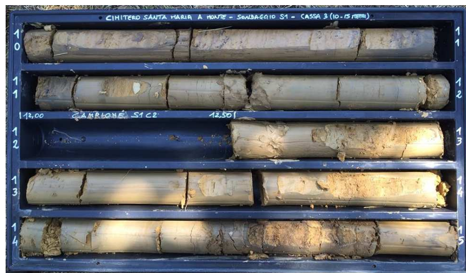
Fig. 4: Sondaggio S1 - Casseta n.3 (da 10 a 15 metri)
